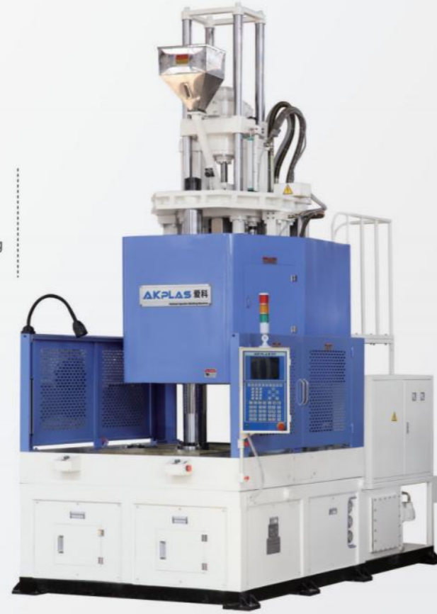
AT-2500.2RL 锁模力 250T Clamping Force 射出量 450-800g Shot Weight
