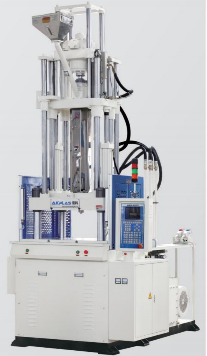
AT-3800 锁模力 380T Clamping Force 射出量 800-1500g Shot Weight
